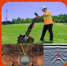
O **Radar de Penetração no Solo - GPR** utiliza o princípio de emissão e recepção de ondas de rádio através do solo. O GPR é capaz de "escanear" o subsolo por onde o equipamento passa gerando imagens dos objetos enterrados independente do tipo de material (metal, PVC, concreto, etc).
